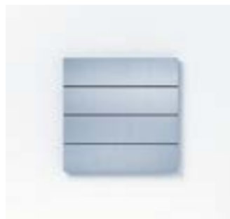
OSB 0004 E Orienteringsskilt i ædelstål, firdelt, til individuel tekst. Den børstede overflade af ædelstål består af fire lige store påskriftsfelter og kan påskrives med laser, folie, gravure eller multiplex. Skriftfeltstørrelse (mm) b x h: 154 x 37,75 Mål (mm) b x h x d: 154 x 154 x 11
