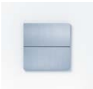
OSB 0002 E Orienteringsskilt i ædelstål, todelt, til individuel tekst. Den børstede overflade af ædelstål består af to lige store påskriftsfelter og kan påskrives med laser, folie, gravure eller multiplex. Skriftfeltstørrelse (mm) b x h: 154 x 76,5 Mål (mm) b x h x d: 154 x 154 x 11
